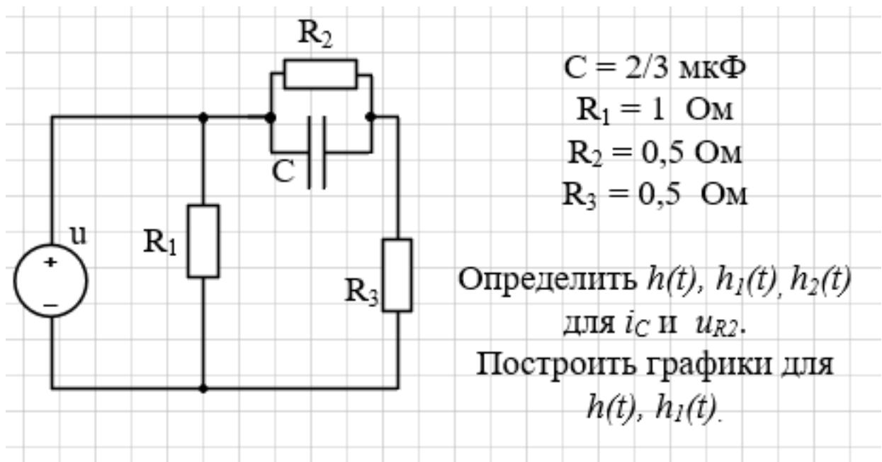
Контрольная работа № 3. Расчет электрических цепей методом комплексных амплитуд.
