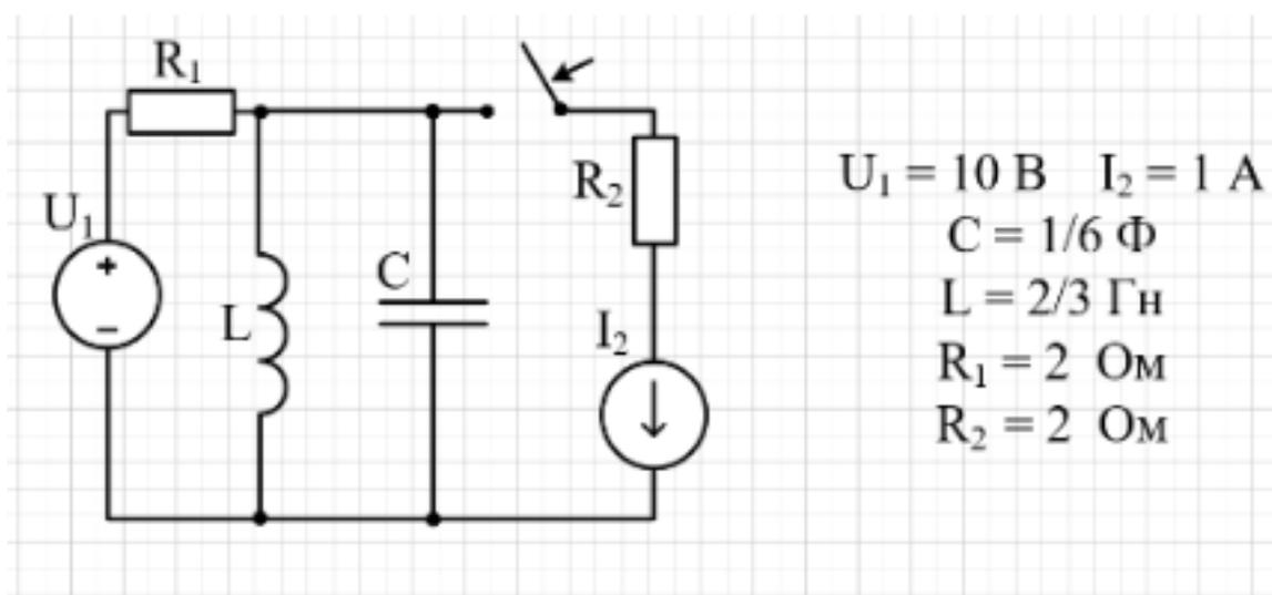
Контрольная работа № 3 Нахождение передаточной функции цепи, импульсной, переходной и частотных характеристик для указанной функции
