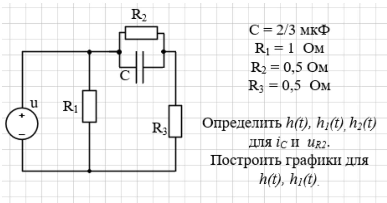
Контрольная работа № 2 Составление системы уравнений состояния в динамической цепи 2-го порядка после коммутации. Нахождение корней характеристического полинома.
