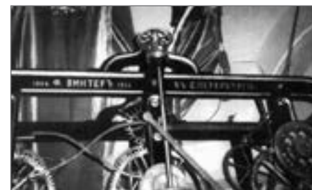
Часть механизма часов в башне Городской Думы в Петербурге с клеймом фирмы «Фридрих Винтер»
