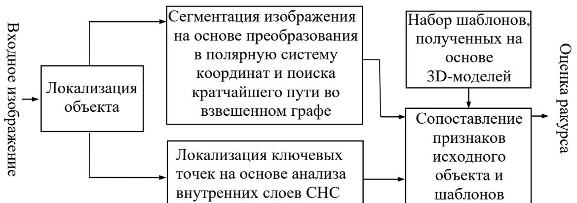
Рисунок 1 – функциональная схема каскадного подхода оценки ракурса ТС.
