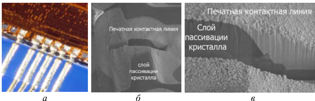
Рисунок 3 – Контактное печатное соединение к выводам ИМС:
