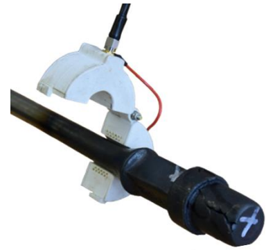
Рисунок 5 – Разъемный ЭМАП на объекте контроля
