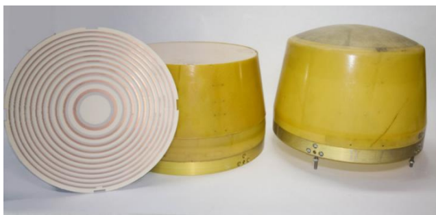
Рисунок 3 – Макет плоского и параболического трансрефлектора АППП диаметром.
