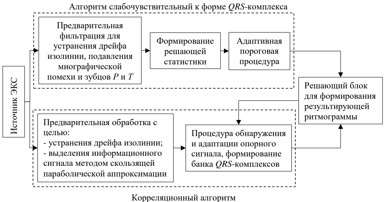
Рисунок 1 – Структурная схема комплексирования корреляционного алгоритма обнаружения ЭКС и алгоритма слабочувствительного к форме QRS -комплекса
