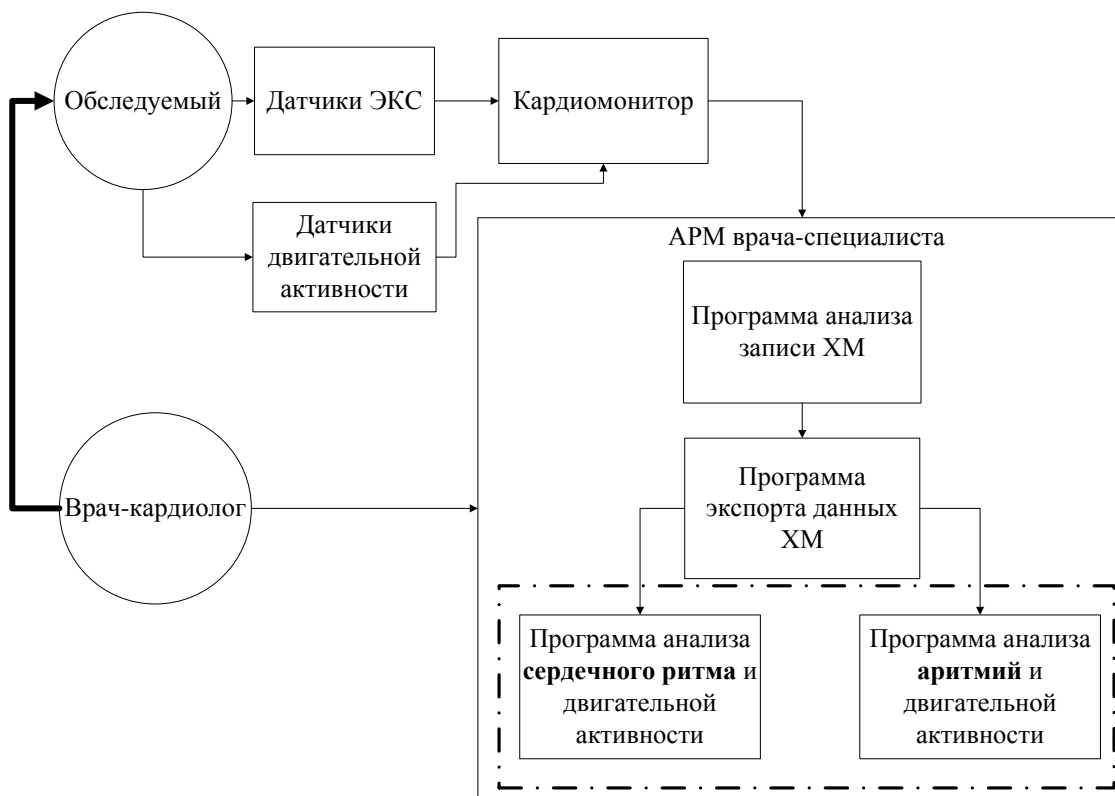
Рис. 2 – Структурная схема системы мониторинга нарушений сердечной деятельности, обусловленных двигательной активностью
