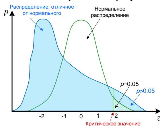
Рисунок 10 – Распределение плотности вероятностей случайной составляющей погрешности результатов измерений
