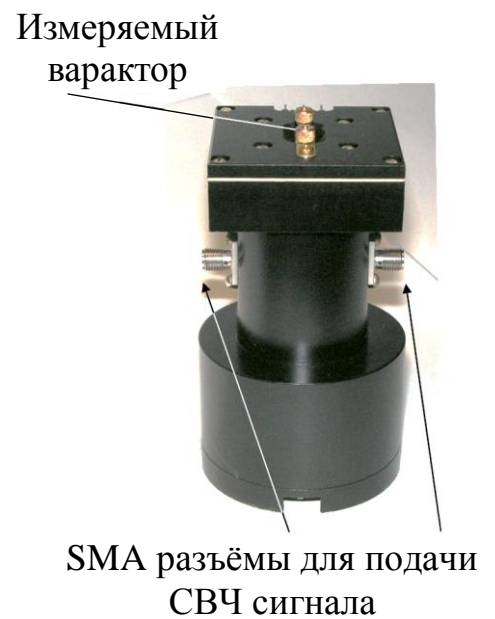
Рисунок 4 - Фото измерительного резонатора на частоту: 3 ГГц
