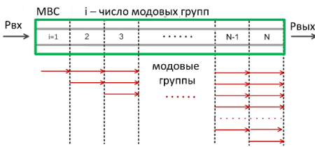
Рис. 7 Иллюстрация МВС с расширением модового состава вдоль продольной координаты. Стрелками условно обозначены возбужденные модовые группы.
