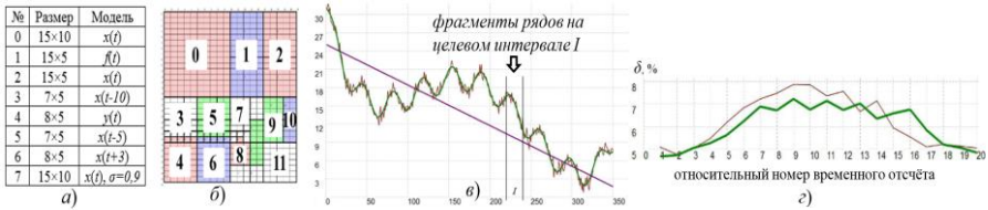
Рисунок 3. Сгенерированные данные: а) априорная система кластеров, б) апостериорная система кластеров, в) примеры профилей рядов, г) осреднённая по кластерам ошибка прогноза (тонкая линия – НВП, толстая – УВП-ARX)
