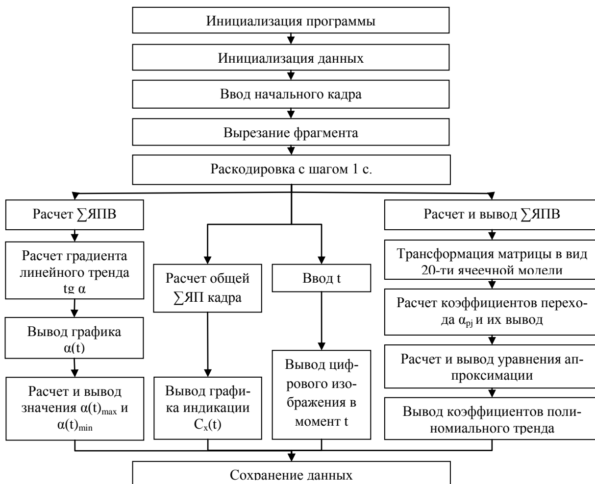
Рис. 8. Общая схема, разработанных программ, реализующих: а - определение коэффициентов перехода по разработанной математической модели; б - комплексную оценку информативных параметров таксических реакций инфузорий.
