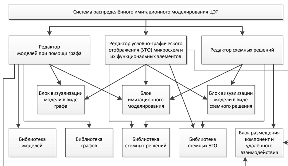
Рисунок 8 – Структура системы распределённого имитационного моделирования цифровой электронной техники.
