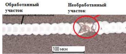
Рисунок 4 - Дефекты скрайбирования, вызванные нарушением фокусировки излучения на поверхности пленки
