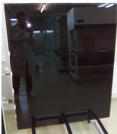
Рисунок 8 - Общий вид изготовленного солнечного модуля размером 1100 мм x 1300 мм с применением промежуточного отражателя
