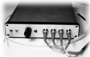
Рисунок 9. Фотография ВОСС на базе четырехканального интерферометра с микромеханическим преобразователем
