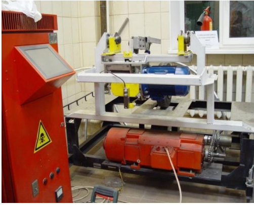
Рис. 5 – Исследовательский стенд с установленной на нём подвеской имитатора тормозных режимов
