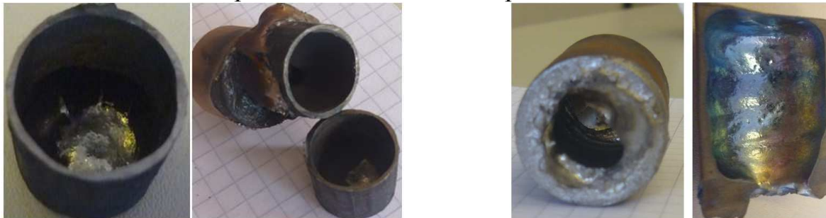
Рисунок 11 – Заготовка Ø20x30мм после нагрева (слева) и результат эксперимента с заготовкой Ø30x35 (справа).
