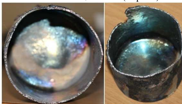
Рисунок 12 – Половина заготовки Ø60x100мм – стенка гарнисажа ~ в 2 мм.
