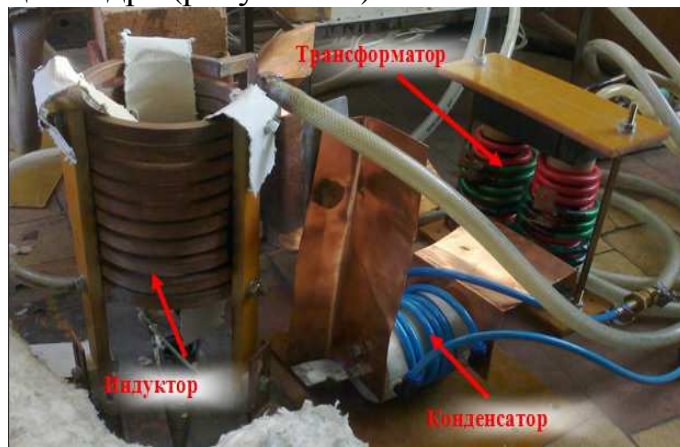
Рисунок 13 – Макет экспериментальной установки для нагрева заготовок Ø60x100мм на 66кГц
