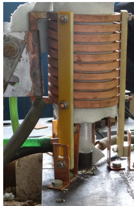
Рисунок 10 – Макет экспериментальной установки для нагрева заготовок \varnothing 60 \times 100 \text{ мм} на 4кГц
