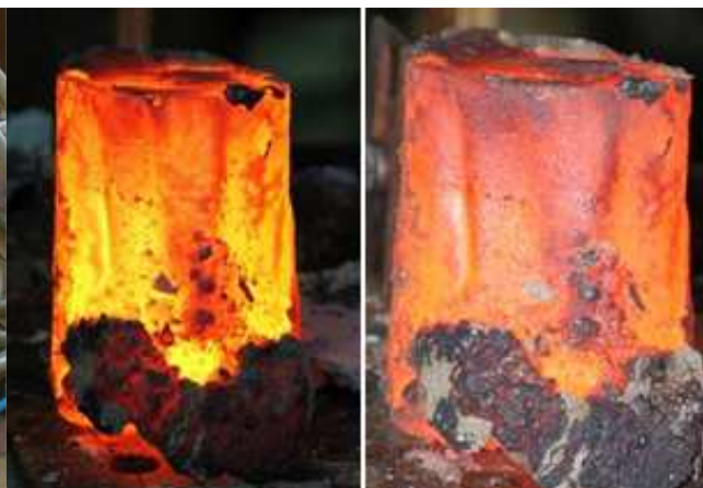
Рисунок 14 – Результат эксперимента на частоте 66кГц. Поверхность заготовки расплавлена
