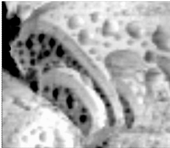
Рис. 5. Латерально-силовая микроскопия разрезанного зондом зерна фоточувствительного слоя на основе Pb_{1-x}Cd_xSe , x=0.04 , размер сканируемой области 2 \text{ мкм} * 2 \text{ мкм} [10]
