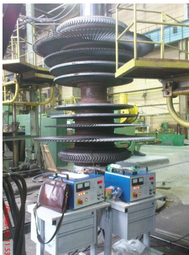
Рисунок 14. – Нагрев рабочего колеса пятой ступени для снятия с посадки
