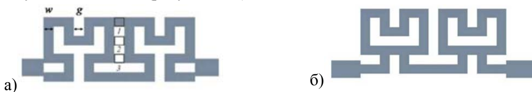
Рисунок 13. (а) CLC ФНЧ на основе ДКГ. Положение среднего короткозамкнутого участка может варьироваться для точной настройки. (б) Топология LCL ФНЧ на основе ДКГ.
