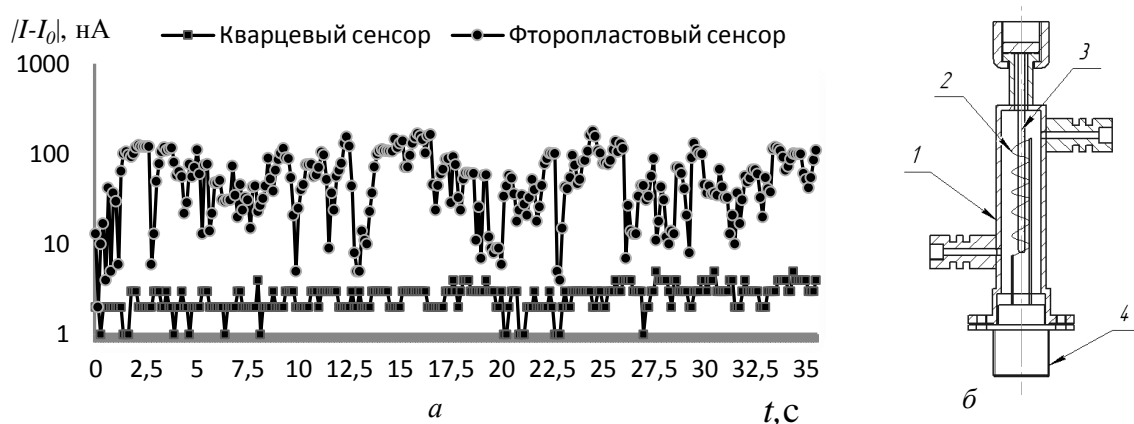
Рисунок 4. Колебания тока сигнала при использовании кварцевого и фторопластового сенсоров (а); конструкция узла сенсора течеискателя (б): 1 – корпус сенсора, 2 – нагреватель, 3 – сенсор на основе капилляра, 4 – разъем питания
