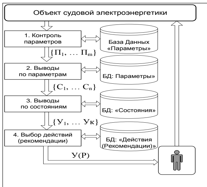
Рис. 1. Структура процесса принятия решений в оперативном управлении объектами судовой электроэнергетики
