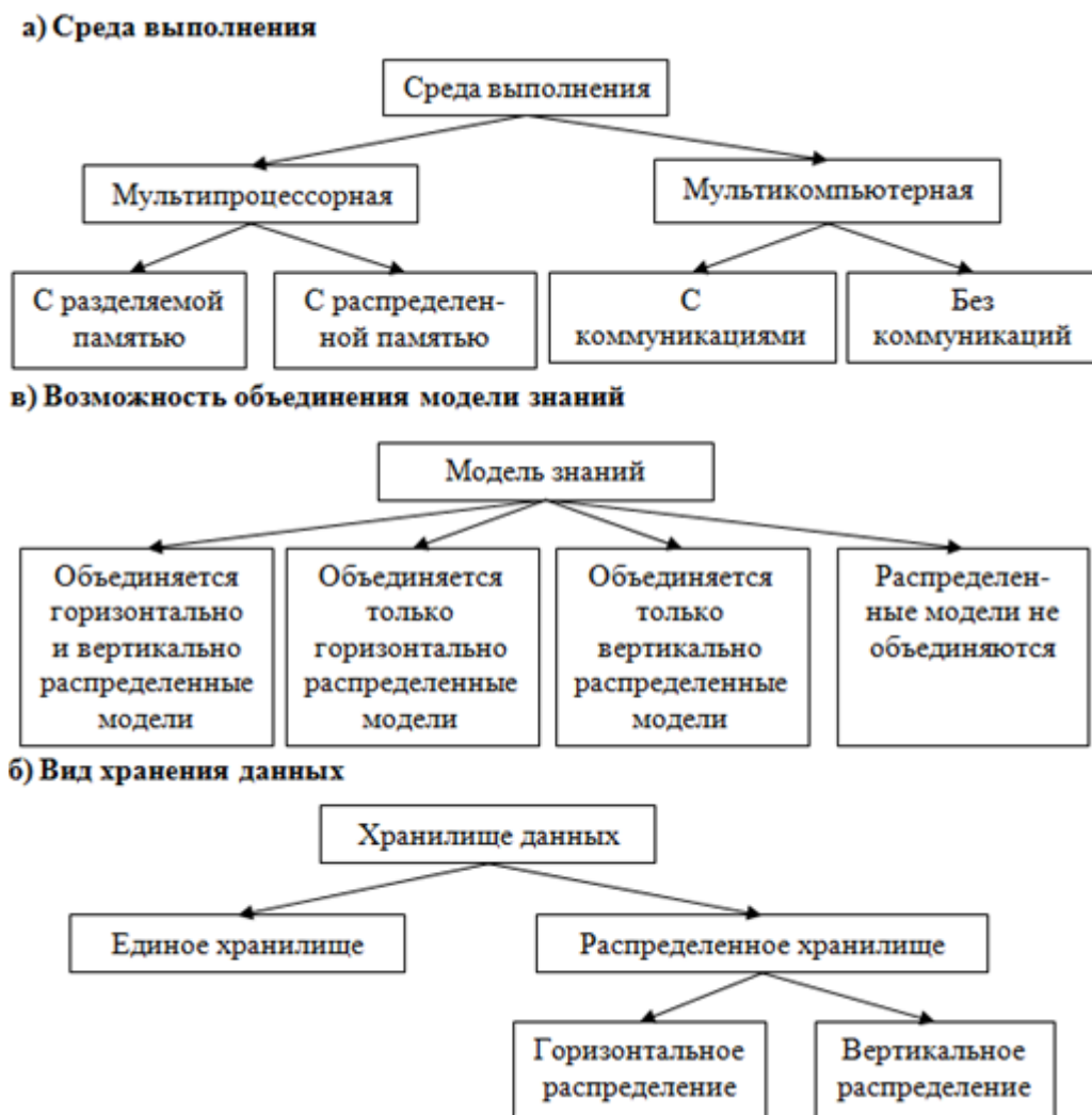
Рисунок 4. Исходные данные для методики распараллеливания алгоритмов ИАД.
