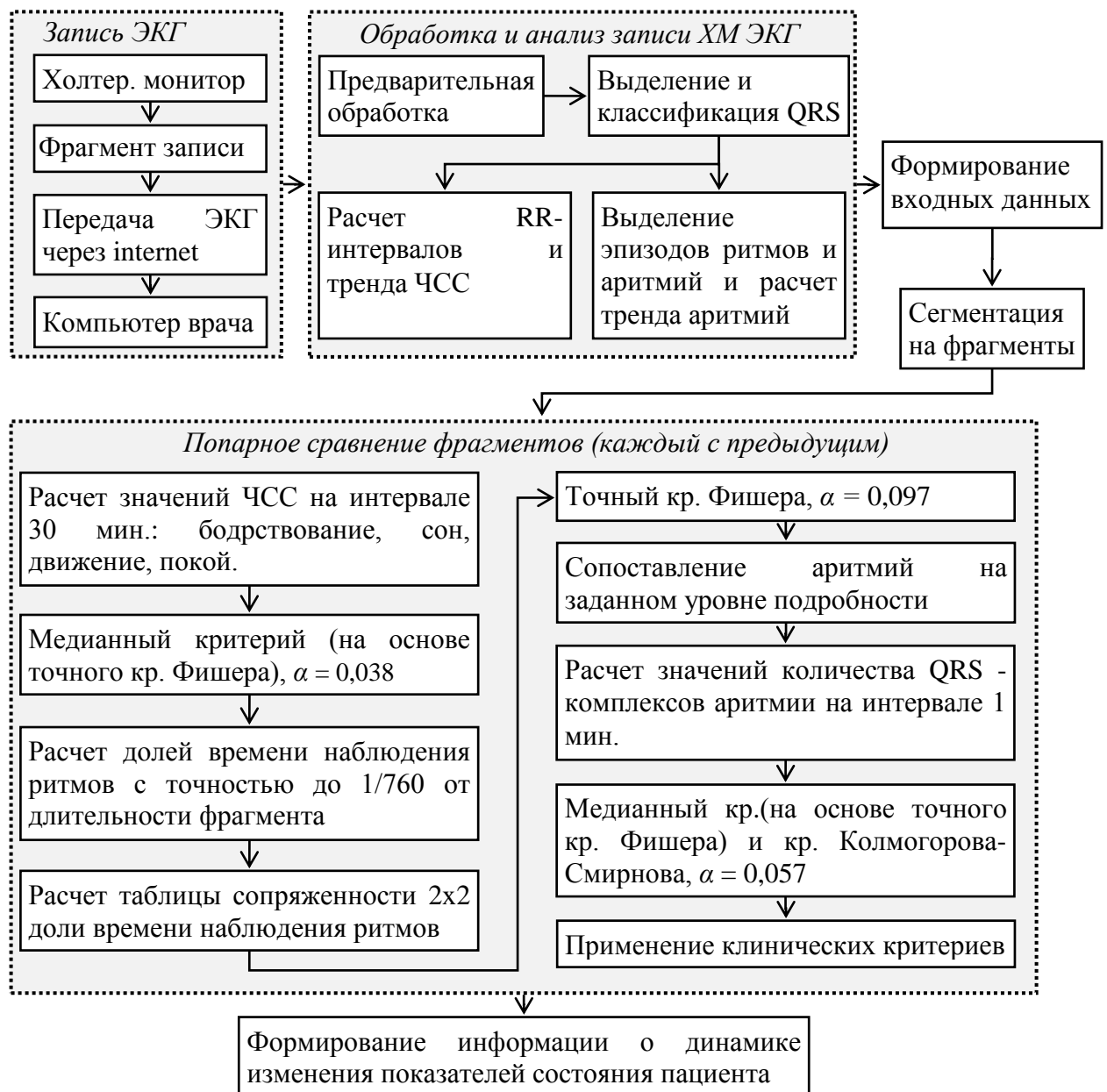
Рисунок 5 - Функциональная схема метода автоматической оценки динамики показателей состояния пациента по данным многосуточного ХМ
