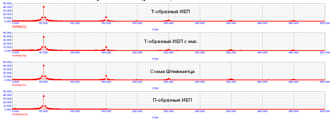
Рисунок 9 – Гармонический состав сетевых токов ИЕП при заряде емкостных накопителей.
