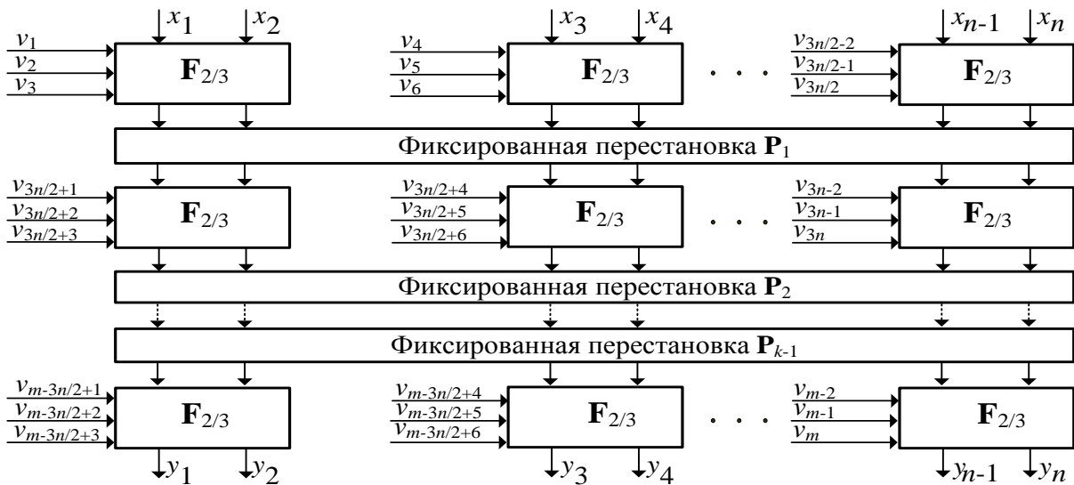
Рисунок 7. Слоистая структура УППС F_{n/m} на основе УЭ F_{2/3}
