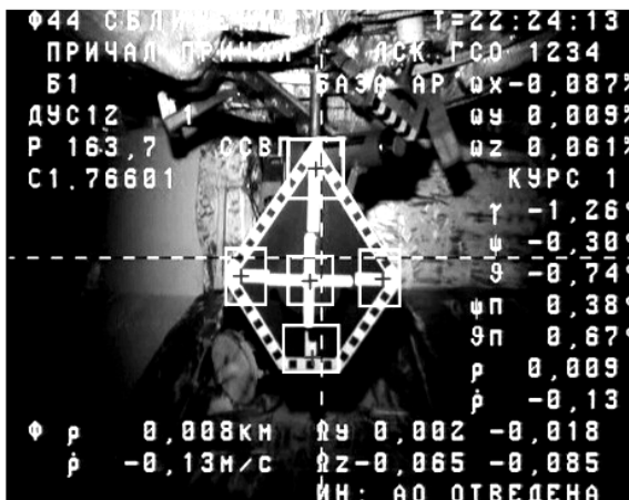
Рис. 8. Пример обработки кадра изображения мишени с обнаружением и измерением координат опорных точек
