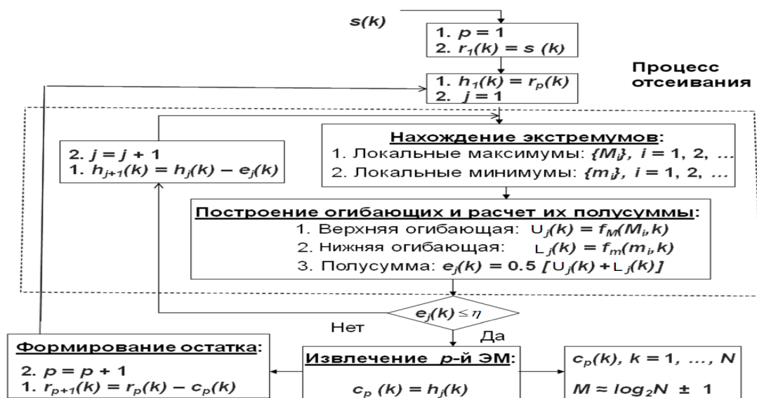
Рисунок 1. Схема разложения сигнала по методу ДЭМ
