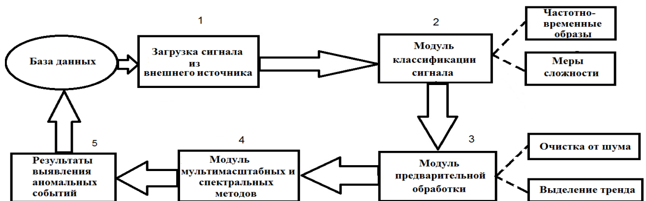
Рисунок 2. Структурная схема комплекса программ
