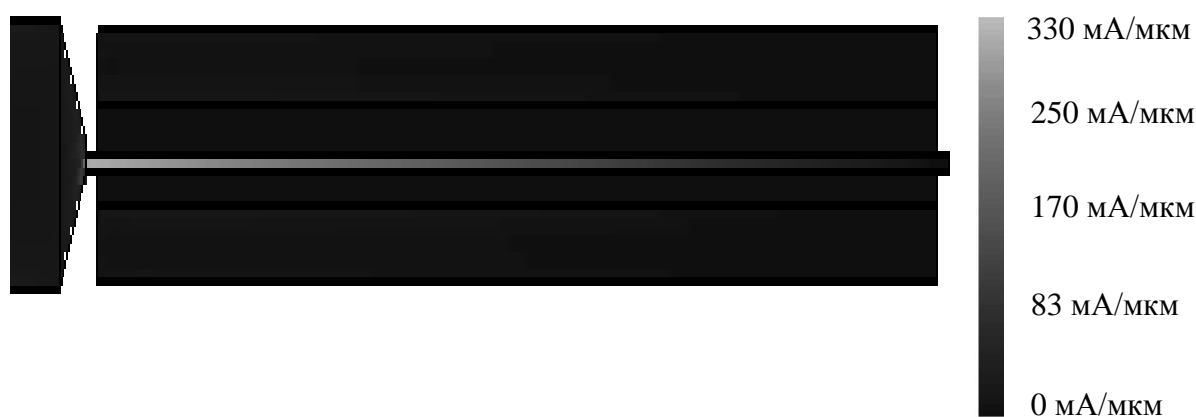
Рис. 7. Распределение линейной плотности высокочастотного тока в затворе транзистора
