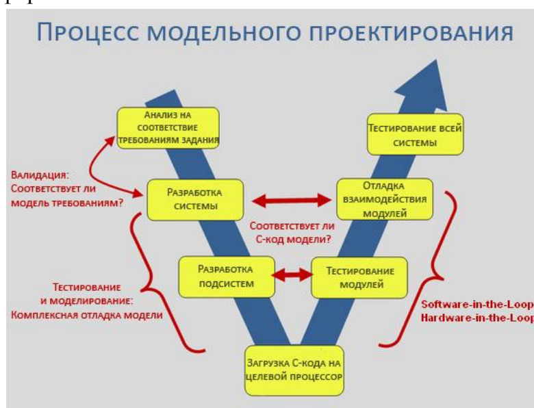
Рисунок 1 - Схема процесса проектирования в рамках Model-Based Design
