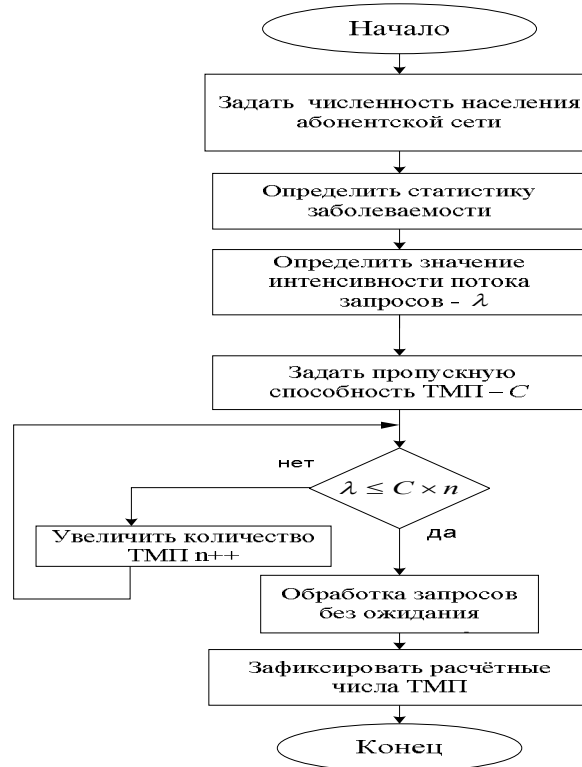
Рисунок 2 - Схема алгоритма расчёта количественного состава элементов телемедицинской сети.
