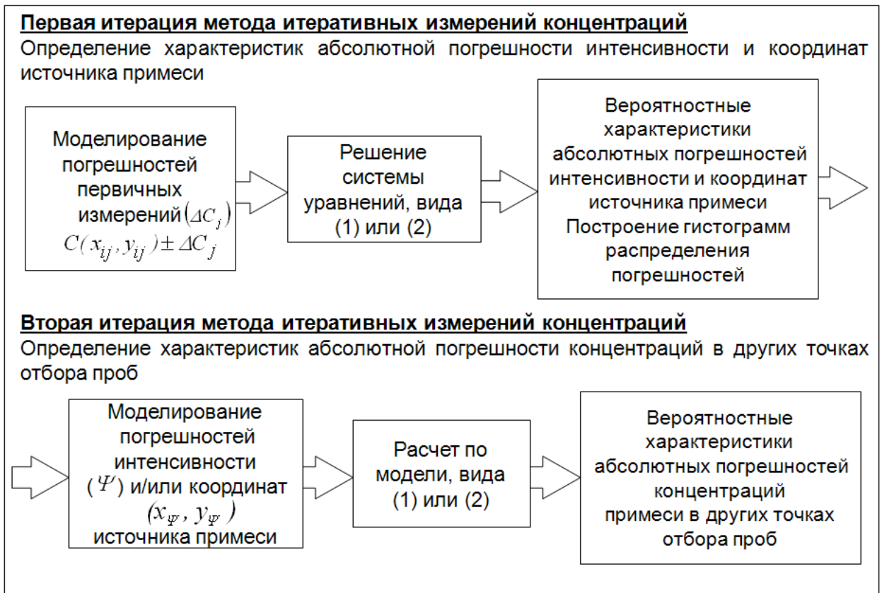
Рисунок 2 – Процедура комбинированного метрологического анализа
