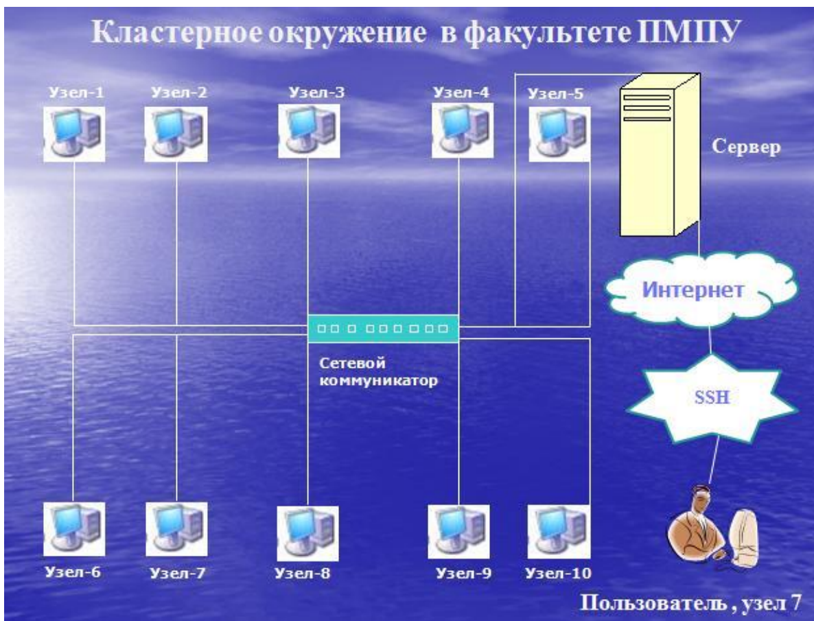
Рисунок.3. Кластерное окружение и запуск приложения WRF с помощью SSH
