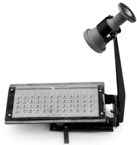
Рис. 2. Решетка из 48 управляемых вибраторов. В правом верхнем углу виден первичный облучатель
