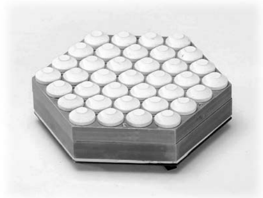
Рис. 5. Внешний вид модуля ФАР на 37 фазовращателей со стороны излучателей
