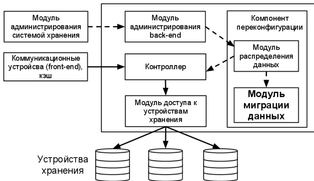
Рисунок 2. Серверная подсистема СХД
