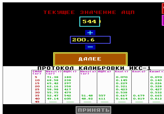
Рис. 22. Заполнение протокола калибровки мобильного комплекса в окне на экране ПУИ
