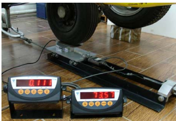
Рис. 21. Калибровочный стенд с установленным на нем измерительным колесо мобильного комплекса (вид со стороны индикаторов VT100)
