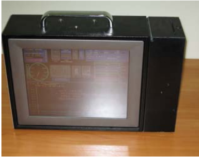
Рис. 14. Компьютерный переносной пульт управления и индикации (ПУИ)
