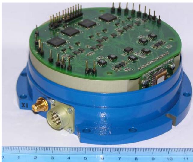
Рис. 6. Бескарданный инерциальный измерительный модуль на ММД
