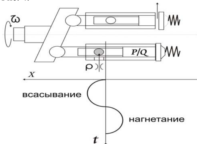
Рис. 4. Принципиальная схема всасывания и нагнетания в аксиально-поршневом насосе с клапанным распределением.
