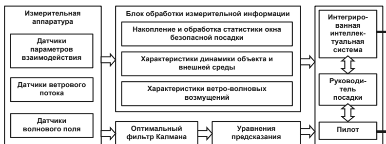
Рис.1. Поток информации о состоянии внешней среды и поведении ДО на волнении
